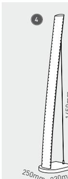
Spannbogen aus Birkeneschichtholz mit Frontabdeckung aus eloxiertem Aluminium, silbermetallisch lackierte MDF-Basis mit Verschluss, inkl. Edelstahlseil.
