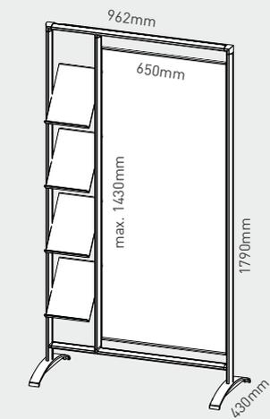
Silber eloxierte Aluminium Profile, Verbinder aus versilbertem Metalldruckguss, Ablagen A4 Kunststoffspritzguss.
