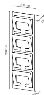
System aus pulverbeschichtetem Metall, glatte Oberfläche, für vertikale Befestigung an die Wand
