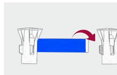
Den selbstziehenden Gurt einfach aus der Kassette ziehen und am nächsten Pfosten in die Halterung einschieben.
