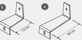
Montage der Wandhalterung, Nutstein einklicken - da kein Einschub, ist das auch nach (!) erfolgter montage möglich - profil montieren. Wandabstand banner: 130mm
