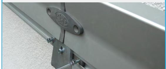
Der Connector für die modulare Gestaltung muss an einer Wandhalterung angebracht werden. Die Profile werden mittels Connector verbunden. Bei Verwendung der Verbinder muss die profillänge je verbinder um 10mm gemindert werden.
